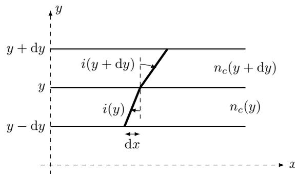
1) On note  $i(y)$  l'angle d'incidence du rayon lumineux à l'ordonnée  $y$ . Écrire la relation entre  $i(y)$ ,  $i(y + dy)$ ,  $n_c(y)$  et  $n_c(y + dy)$ , puis écrire la même équation pour l'interface en  $y - dy$  et pour celle en  $y + dy$ . En déduire que  $n_c \sin i$  est une constante du problème, qu'on notera  $C$ .
