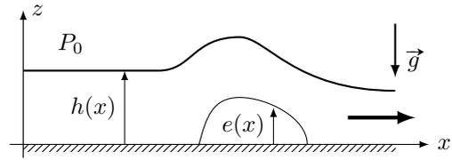
L'eau est assimilée à un fluide parfait incompressible de masse volumique  $\mu$ . Le champ de vitesse est supposé pour simplifier unidirectionnel et uniforme sur une section droite de l'écoulement  $\vec{v} = v(x)\vec{e}_x$ .
