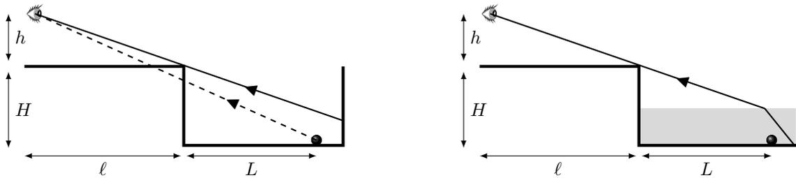
À mesure que l'on remplit la piscine, le phénomène de réfraction permet au rayon rasant le bord de se rapprocher de plus en plus de la pièce (*l'indice de l'eau est plus grand que celui de l'air donc l'angle réfracté est plus petit que l'angle incident*), voir la figure de droite. Considérant ces réflexions préliminaires, on est amenés à travailler sur la situation suivante, où on note  $y$  la hauteur d'eau recherchée.
