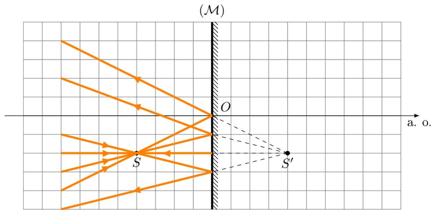
**Propriété.** Le miroir plan est le seul instrument optique **rigoureusement stigmatique et aplanétique**. (*En d'autres termes, et contrairement aux lentilles minces, il n'est pas utile d'être dans les conditions de Gauss pour qu'un miroir plan vérifie ces propriétés.*)
