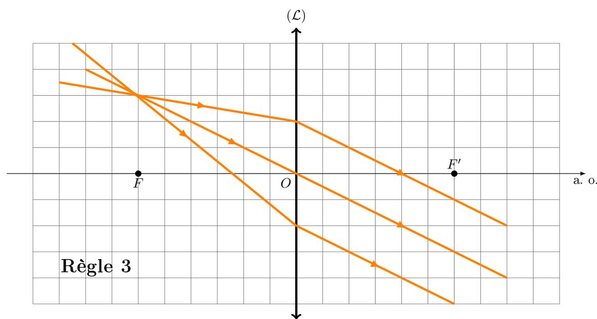
**Propriété.** En conséquence des règles ci-dessus, un rayon lumineux incident parallèle à l'axe optique repart en passant par le point focal image; et un rayon lumineux émergent parallèle l'axe optique est passé par le point focal objet.
