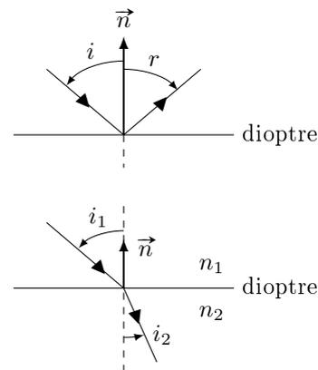
Sur le schéma d'exemple de la réfraction, on observe  $i_2 < i_1$  donc on a  $n_2 > n_1$ .
