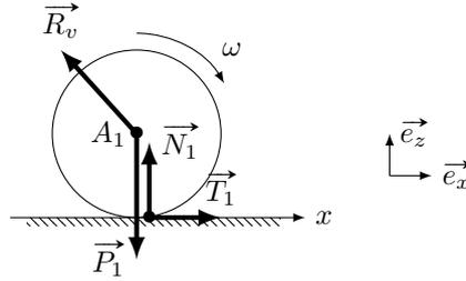
Sur le schéma, on a décalé les réactions du sol pour plus de lisibilité, mais elles s'exercent rigoureusement au point de contact avec le sol, c'est-à-dire à la verticale du centre  $A_1$  de la roue.  $\vec{P}_1$  est le poids de la roue, et  $\vec{R}_v$  est la réaction entre la roue et la voiture (via l'essieu). Le moment cinétique de la roue est
