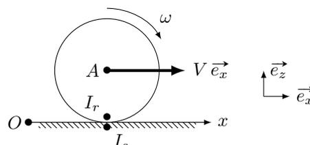
**Définition. Vitesse de glissement.** On définit les deux points **confondus** à l'instant  $t$  (mais légèrement décalés sur le schéma pour la compréhension)  $I_r$  et  $I_s$ , correspondant tous les deux géométriquement au point de contact  $I$  entre la roue et le sol, mais respectivement attachés à la roue (pour  $I_r$ ) et au sol (pour  $I_s$ ). On définit alors la vitesse de glissement par
