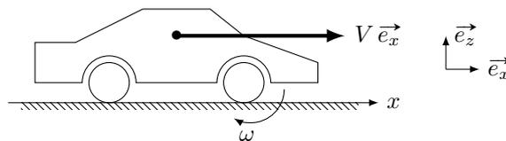
► Attention, il ne faut pas oublier, malgré le schéma qui ne les représente pas, qu'il y a **deux roues avant et deux roues arrière**.
