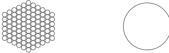
**Figure.** (à gauche) Tresse de fils fins. (à droite) Gros fil unique.
