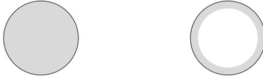
**Figure.** Le courant traverse toute la section du conducteur si  $\delta > r$ , et reste en bordure sur une profondeur  $\delta$  si  $\delta \ll r$ .
