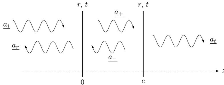
On envoie une onde lumineuse incidente  $\underline{a}_i(z, t) = \underline{A}_i e^{j(\omega t - k z)}$  sur l'interféromètre, sous incidence normale. Les réflexions et transmissions des ondes conduisent à la présence d'une onde réfléchie  $\underline{a}_r(z, t) = \underline{A}_r e^{j(\omega t + k z)}$ , à une onde transmise  $\underline{a}_t(z, t) = \underline{A}_t e^{j(\omega t - k z)}$  et à deux ondes dans l'interféromètre, l'une se propageant vers la droite, l'autre vers la gauche
