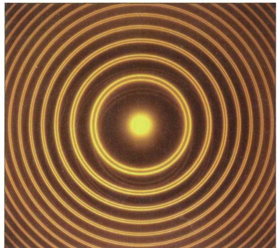
**Remarque :** dans un laser, l'une des deux lames est parfaitement réfléchissante ( $R = 1$ ) et la lumière est créée à l'intérieur de la cavité formée par les deux lames. On parle de cavité Fabry-Pérot.
