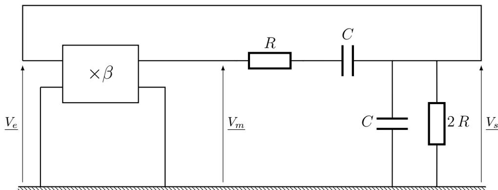
Le quadripôle de gauche est un amplificateur de gain  $\beta$  réel, c'est-à-dire que sa fonction de transfert est
