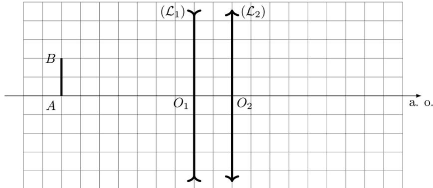
On considère l'objet  $AB$ . La lentille  $\mathcal{L}_1$  en forme une image intermédiaire  $A'B'$ , et la lentille  $\mathcal{L}_2$  forme ensuite l'image finale  $A''B''$  de  $A'B'$ , ce qu'on schématise comme suit :
