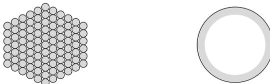
**Figure.** (à gauche) Le courant circule à travers toute la surface, l'épaisseur de peau étant de l'ordre du rayon d'un fil. (à droite) Le courant ne circule qu'à travers une petite surface en bordure de fil, d'épaisseur l'épaisseur de peau. La surface traversée par le courant est ainsi bien plus faible, comparée à la tresse de fils fins ; et la résistance, donc la puissance dissipée, bien plus grande.
