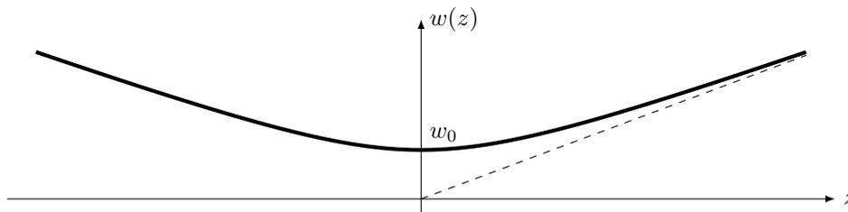
3) Le faisceau est **cylindrique**, donc de rayon constant  $w(z) \approx w_0$ , si  $z \ll z_R$ . À l'inverse, il est **conique** si  $z \gg z_R$ .
