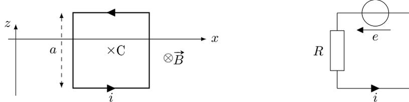
Tant que  $z_C > a/2$ , le cadre est en chute libre. Idem pour  $z_C < -a/2$  (les forces de Laplace se compensent deux à deux). Entre les deux, il y a une variation du flux du champ magnétique dans le cadre. Il y a donc un phénomène d'induction supplémentaire.
