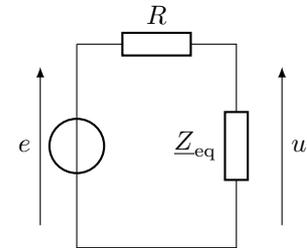
7) On travaille à  $t = 0^+$ . Il y a **continuité de la tension aux bornes du condensateur** soit  $u = E_0$ , donc par loi des mailles  $u_R = 0$  donc  $i = u_R / R = 0$ , soit  $i_1 = -i_2$ . Et  $i_2 = 2u / R = 2E_0 / R$  par loi d'Ohm.
