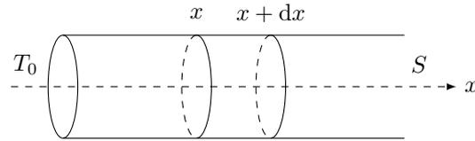
Ce système évacue de l'énergie par sa surface latérale, contrairement au cas étudié dans le cours où les parois latérales étaient calorifugées. Il faut donc reprendre le bilan d'énergie. En régime permanent, l'énergie du système ne varie pas donc on peut écrire entre  $t$  et  $t + dt$
