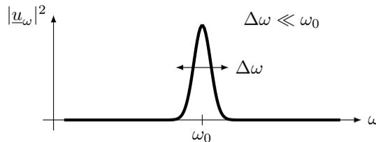
En d'autres termes,  $\underline{u}_\omega$  prend des valeurs significatives seulement au voisinage immédiat d'une pulsation  $\omega_0$ . La représentation spatiale d'un paquet d'onde à  $x$  fixé ressemble à
