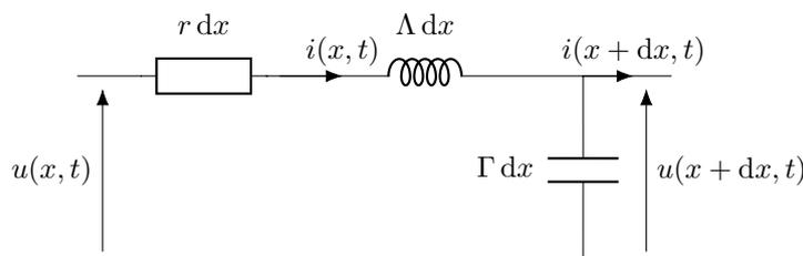
Avec les mêmes notations que précédemment, et en écrivant  $u_r$  la tension aux bornes de la résistance, l'application de la loi des mailles pour ce circuit conduit à
