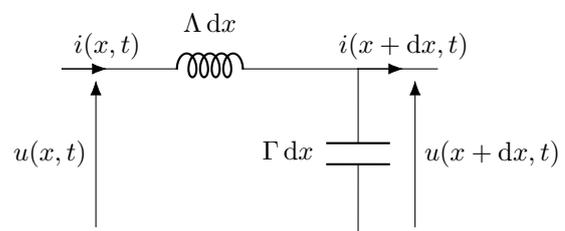
On note  $u_\Lambda$  la tension aux bornes de la bobine (en convention récepteur) et  $i_\Gamma$  le courant (aussi en convention récepteur) dans la branche contenant la capacité. On a donc
