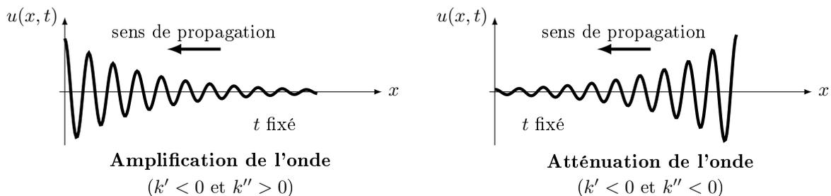
Par ailleurs, dans le cas d'une atténuation, puisque le facteur d'atténuation de l'onde est  $e^{-k'' x}$ , on comprend que l'onde est atténuée sur une distance typique  $\delta$  telle que  $\delta(\omega) = 1 / |k''(\omega)|$ .
