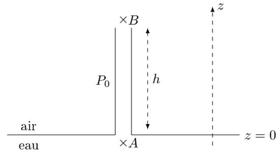
2) Le fluide est parfait et homogène (c'est de l'eau), en écoulement incompressible et stationnaire. On peut donc appliquer le théorème de Bernoulli à la ligne de courant qui va de  $A$  à  $B$ . Il s'écrit
