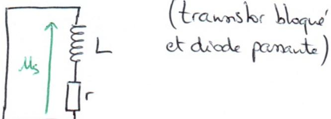
(transistor bloqué et diode passante)
