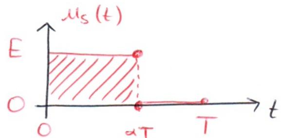
5] On détermine le taux d'ondulation grâce aux expressions de  $i_s(t)$ : (1) et (2). Dans ces équations, en supposant la fonction affine par morceaux, on a
