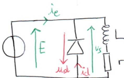
Par loi des mailles,  $E = u_s$ . En notant  $u_d$  la tension aux bornes de la diode (en convention récepteur), on a évidemment  $u_d = -u_s = -E < 0$
